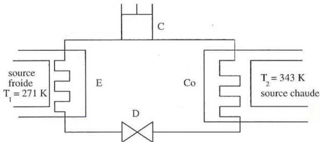
Tout est parfaitement adiabatique sauf au niveau du condenseur où le fréon échange la quantité de chaleur  $Q_2$  avec la source chaude et au niveau de l'évaporateur où le transfert de chaleur avec la source froide est  $Q_1$ . Le fluide reçoit, au niveau du compresseur, un travail  $W$ .
